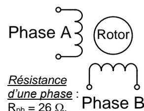
fig. 4 : structure des moteurs PAN et TILT
