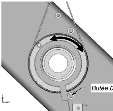
La poulie poursuivant sa rotation dans un sens ou dans l'autre. La rondelle indexeur reste dans sa position.
