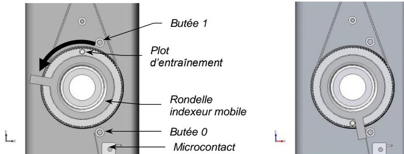
La poulie poursuivant sa rotation, le doigt de la rondelle indexeur va venir actionner le microcontact qui permettra de référencer la position 0. La butée 0 évite toute poursuite du mouvement.
