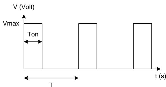
Rapport cyclique  $\alpha = \text{Ton}/T$  de la Modulation de largeur d'impulsion ( $V_{\text{moyen}} = \alpha \cdot V_{\text{max}}$ )
