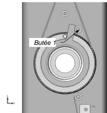
En cas de défaillance, le doigt de la rondelle indexeur va buter contre la butée 1 : le système est stoppé.
