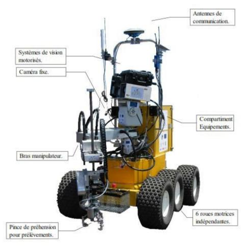
Le robot mobile est piloté à distance depuis le poste de contrôle. L'opérateur visualise en permanence les images transmises par la caméra embarquée, et reçoit cycliquement des
