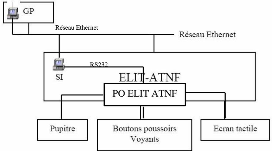
Le pupitre dispose des boutons de mise en service de l'ELIT-ATNF (Mise en marche, arrêt, arrêt d'urgence, ...)
