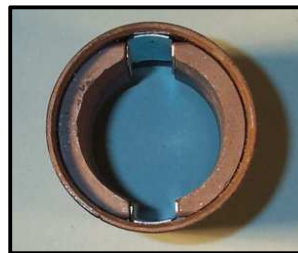
Aimants permanents (moteur bipolaire)
