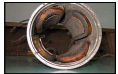
Bobinages enroulés autour des pôles du stator (moteur tétrapolaire)
