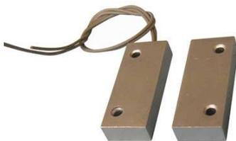
Le détecteur ILS se compose de 2 lames conductrices (tête de détection). L'approche ou le passage d'un objet magnétique ou d'un aimant entraîne la déformation de ces lames, celles-ci entrent en contact et permettent le passage d'un courant électrique.
