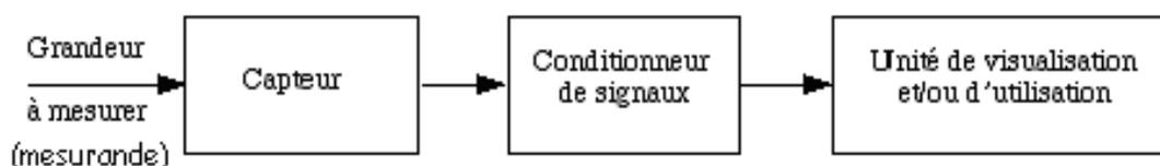
Figure 9 : Synoptique simplifié d'une chaîne d'acquisition
