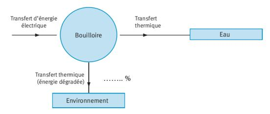
1. A partir du principe de conservation de l'énergie, calculer l'énergie électrique absorbée par la bouilloire.
